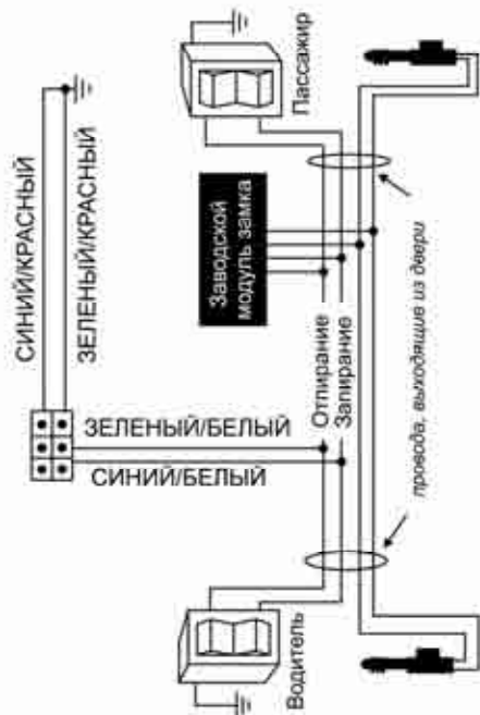
Зеленый/Черный и Синий/Черный провода системы не используются. Изолируйте их отдельно друг от друга
