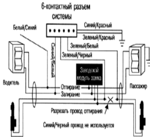
Схема 7. Отрицательный триггер - отпирание первоначально только двери водителя
