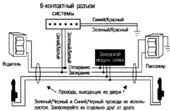
Схема 1. Отрицательный триггер (большинство автомобилей японского производства)
