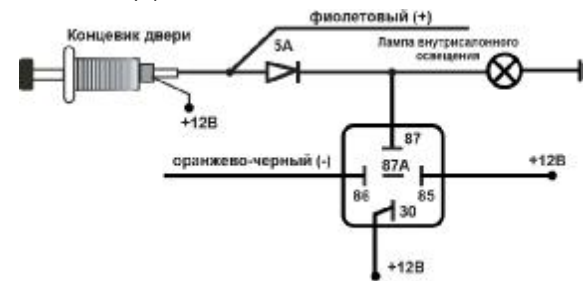
Схема подключения при включении режима охраны с работающим двигателем или турбо таймером.
