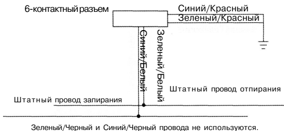
Схема 1. 3-проводная система с отрицательной полярностью (большинство японских автомобилей)
